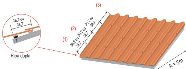
É importante sempre utilizar como referência dimensional a própria telha que será utilizada na montagem do telhado.
